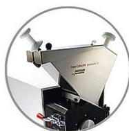
Funil de alimentação padrão, em forma de “V”, com embolo prensador de um dos lados e tampa móvel para introdução da amostra do outro lado, 3 litros, catálogo 25.2850.00.
