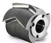
Conjunto padrão de ferramentas de corte, constando de rotor, facas móveis com borda cortante em “V”, de aço ferramenta, e facas fixas, de aço ferramenta, catálogo 45.7000.00. Possui ação de corte suave.
