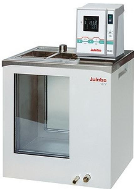
Banho termostático para viscosímetros cinemáticos, modelo ME-18V, catálogo 9162518. As unidades oferecem alta precisão e ótima distribuição da temperatura em todo o banho. Estão equipadas com suporte para termômetros e podem oferecer opções para procedimentos de calibração de temperatura e compará-los com termômetros acreditados.
